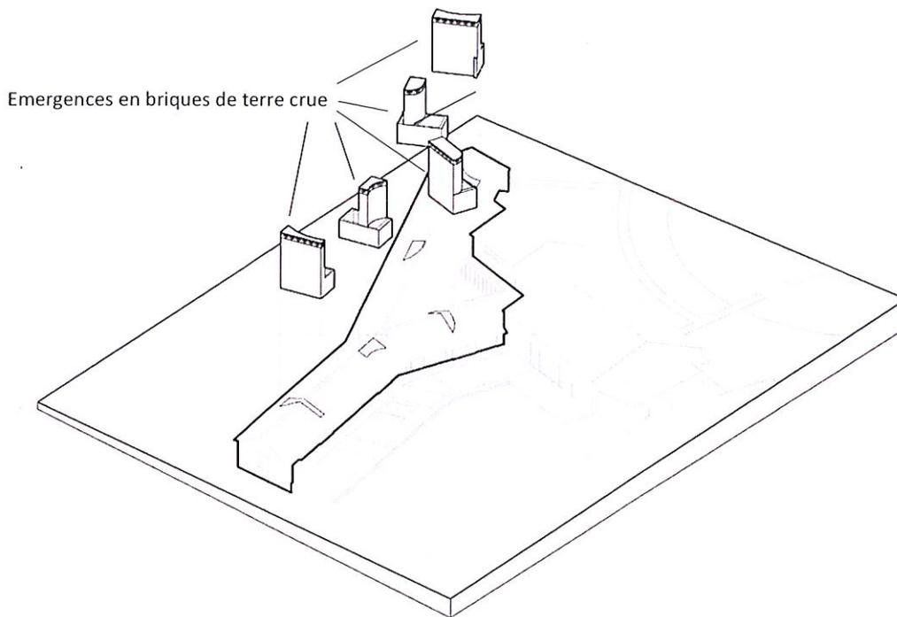
Chacune des émergences intègre un circuit de ventilation naturelle double-flux low-tech compatible avec la RE2020 et qui ne nécessite aucun besoin d'électricité. Sans maintenance et avec le minimum d'entretien, elles permettent de ventiler les salles d'activité, les sanitaires, les couloirs et pièces techniques. Elles assurent également un apport de lumière naturelle zénithale
